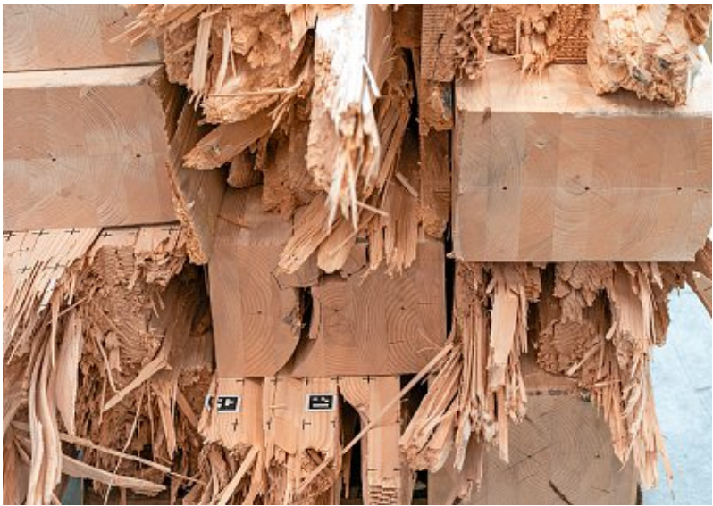
Auf Biegen und Brechen: In der Werkstatt der ETH am Hönggerberg in Zürich wird das Holz einem Härte- und Biegetest unterzogen.
